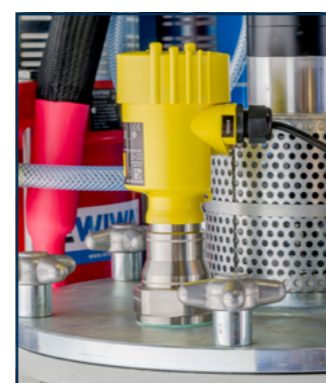
Radarsensoren für die Füllstandskontrolle
