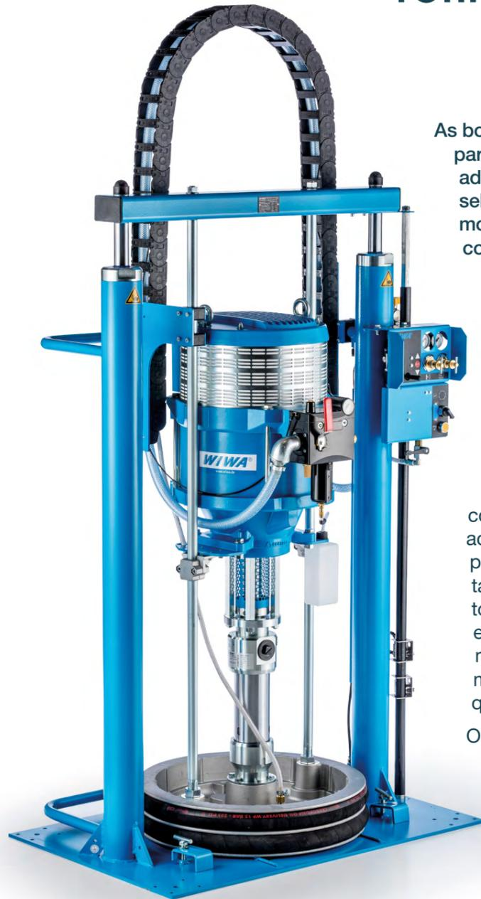
As bombas de extrusão **WIWA VULKAN GX** para o transporte, dosagem e aplicação de adesivos, materiais isolantes e materiais de selagem dependem agora também do novo motor pneumático WIWA GX. Isto impressiona com uma carcaça metálica completa, distribuição de ar otimizada durante o funcionamento para minimizar o gelo durante o funcionamento contínuo e redução do ruído.
